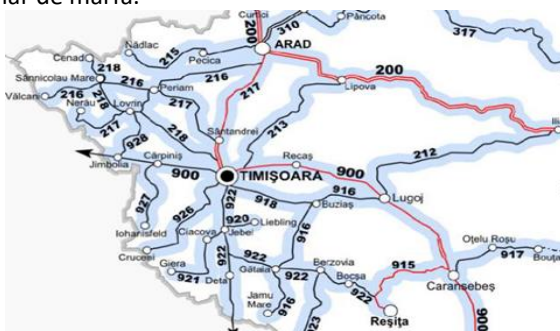
Fig. 19: Rețeaua feroviară a județului Timiș (roșu = linii electrificate)
